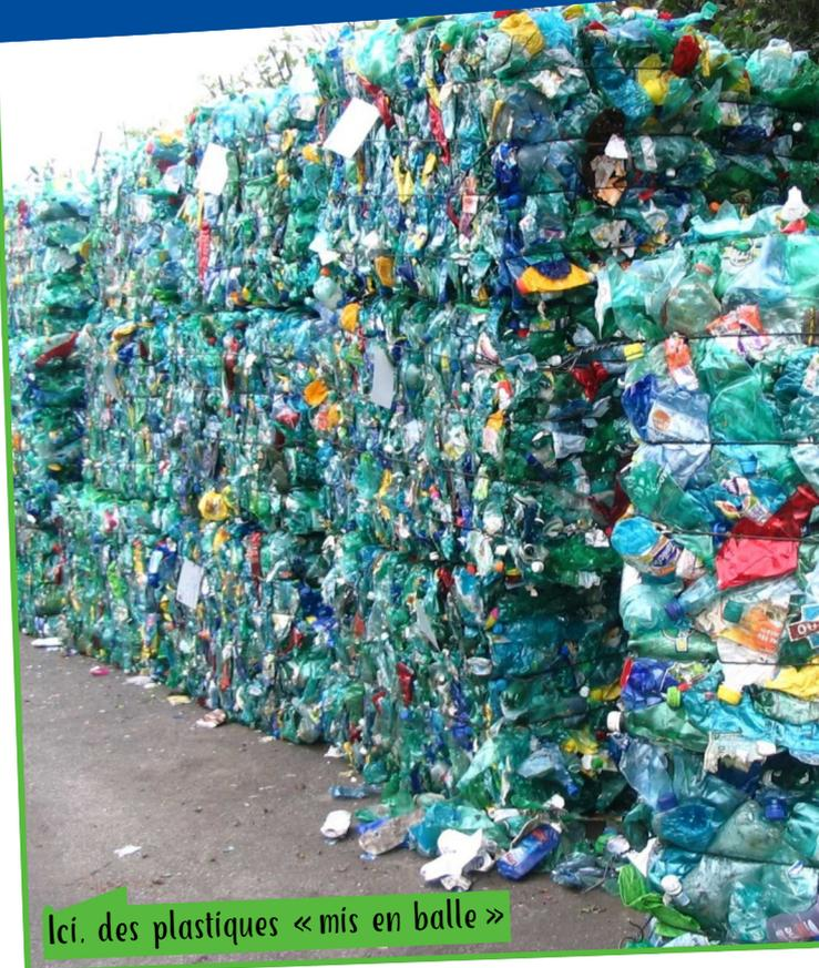
Une fois triés, les emballages usagés sont mis en balle et partent pour des usines de régénération en France et en Europe. Les repreneurs sont une dizaine à fabriquer des paillettes de différentes couleurs à partir d'emballages plastiques. Lavées et chauffées à haute température, les paillettes sont transformées pour servir de matières premières à la fabrication d'une multitude d'objets en plastique dont la qualité est proche de celle des plastiques vierges.
